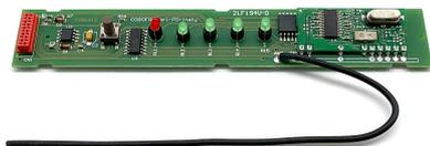
Scheda elettronica di comando con tecnologia soft touch e radiofrequenza. Dotata di un pulsante ON-OFF per accensione e spegnimento del sistema, 4 led verdi + 1 led rosso di segnalazione di stato. È comprensiva di modulo ricevente in radiofrequenza 433 MHz a scelta tra super iterativo o rigenerativo. Ha la possibilità di un telecomando di appoggio sempre in radiofrequenza tarabile e programmabile per l'apparecchiatura a cui è dedicato e, soprattutto, il firmware è personalizzabile.
